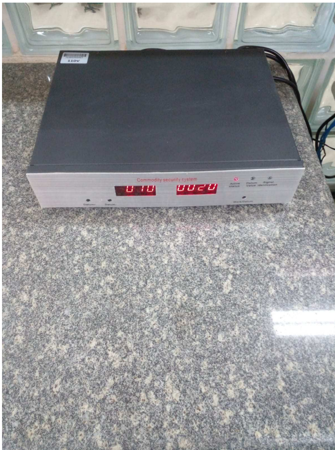
Figura 4: Central de controle com tecnologia eletromagnética/acústico. Contém contador de fluxo.
